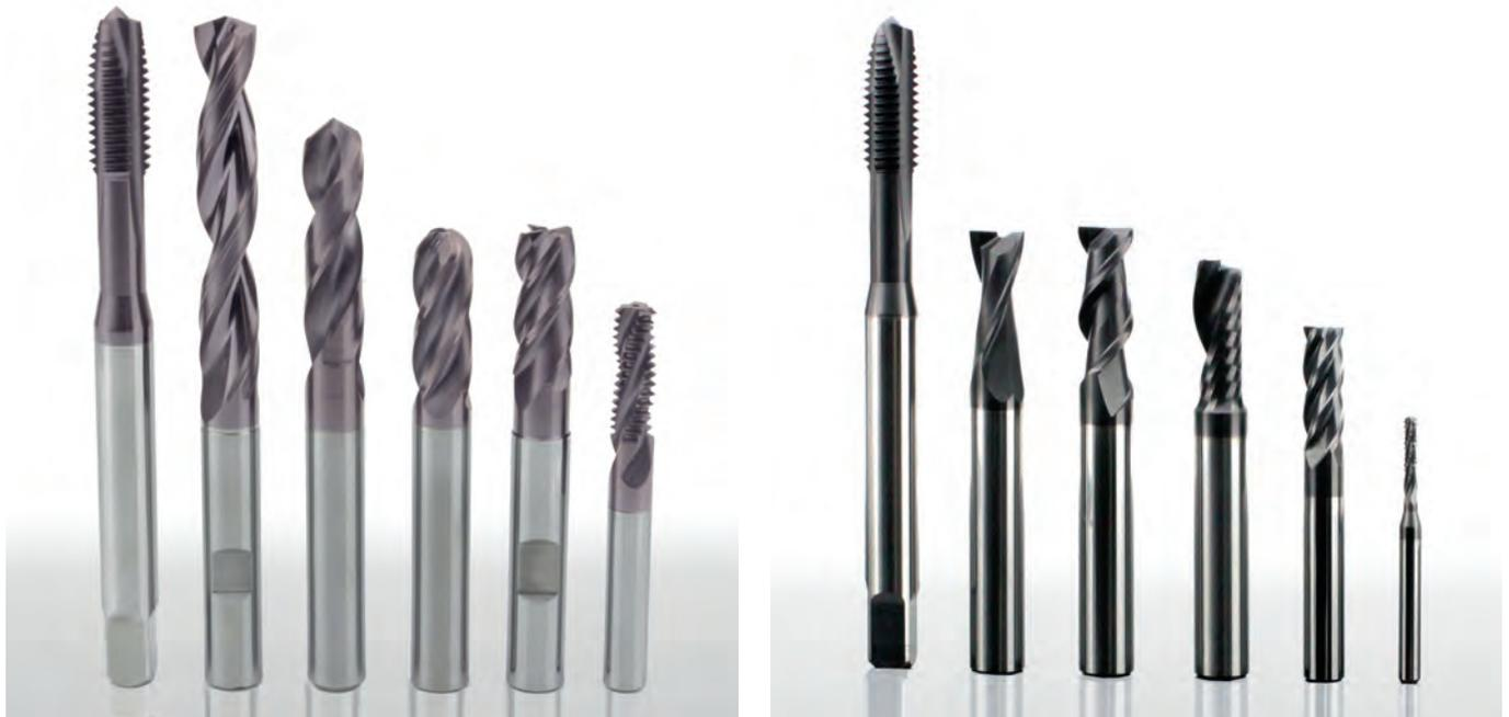
Links: Selbstadaptive Multifunktionsschichten: MpC-beschichtete Präzisionswerkzeuge. Rechts: ta-C: konturtreue und präzise Werkzeugbeschichtung für die Bearbeitung von Al-Legierungen bis 12 % Si, MMCs, Holz und Papier. (Bilder: Surcoatec Deutschland)
